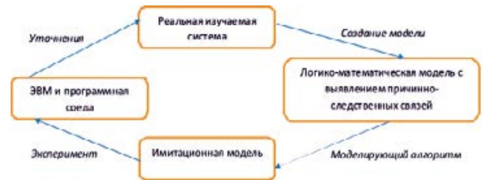
Рис. 1. Элементы имитационной модели и процесс моделирования
